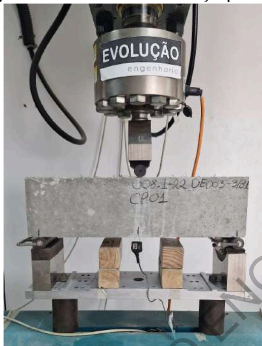
Figura 18 - Ensaio de resistência à tração por flexão
