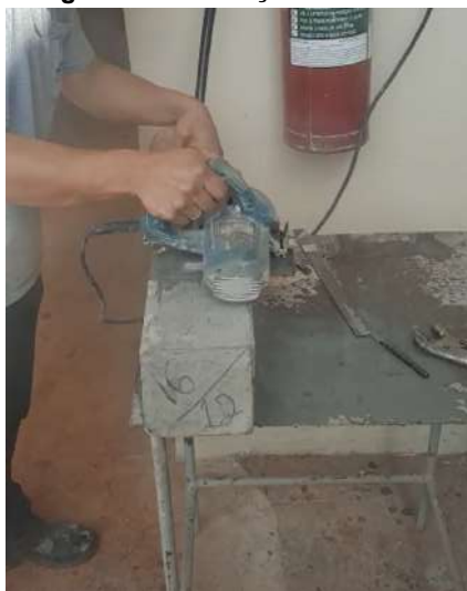
Figura 6 - Realização do entalhe
