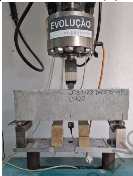
Figura 21 - Ensaio de resistência à tração por flexão
