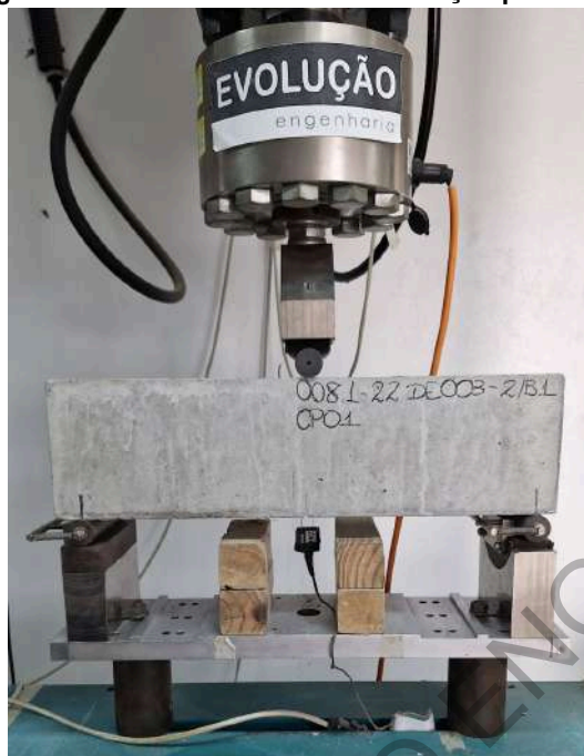
Figura 15 - Ensaio de resistência à tração por flexão
