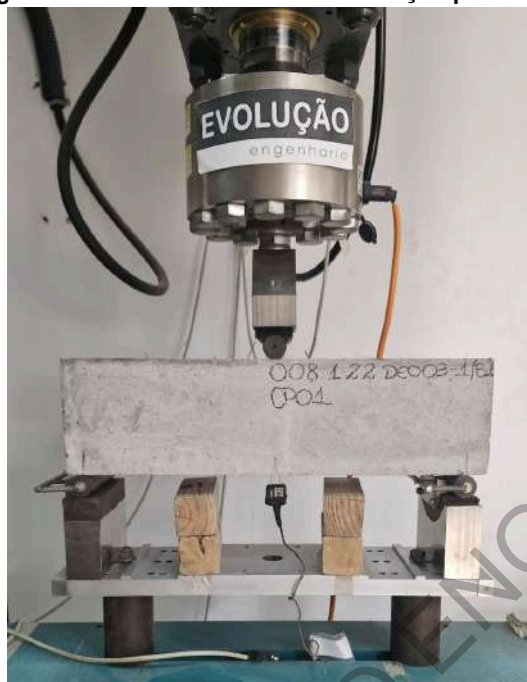
Figura 12 - Ensaio de resistência à tração por flexão
