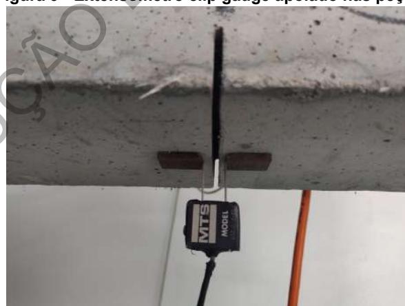
Figura 9 - Extensômetro clip gauge apoiado nas peças
